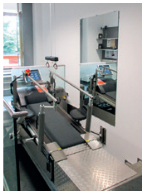
Grubeninstallation eines locomotion®
