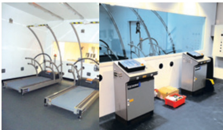
zwei Klimakammer-Laufbänder mit externen Bedieneinheiten außerhalb der Klimakammer geeignet für folgende Umgebungsbedingungen: Temperatur -35 ... +50°C und Luftfeuchtigkeit bis zu 100%
