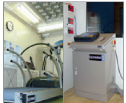
Speziallaufband für Klimakammer-Installation mit Fernsteuerung
