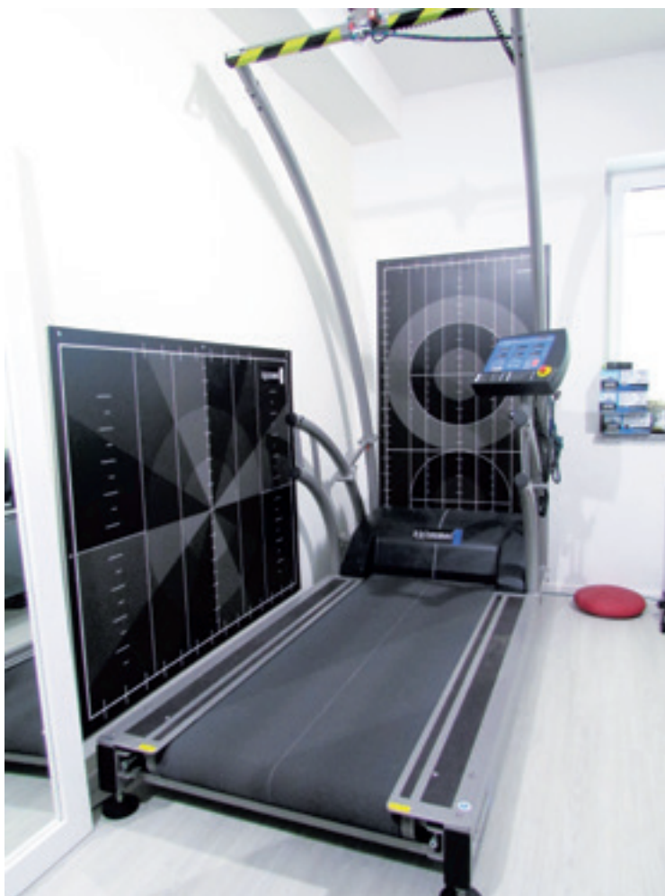
quasar® med mit Sicherheitsbügel und h/p/cosmos Kalibrierungstafeln in einem Ganganalyselabor
