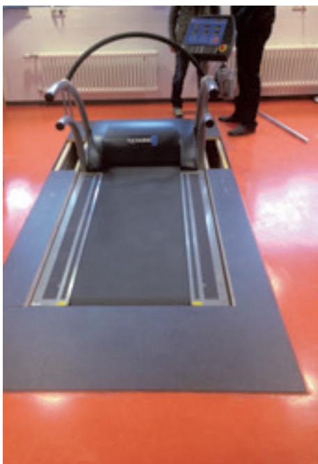
quasar® med installiert in einer Grube
