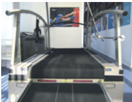
saturn® 300/100rs mit Rollstuhlrampe und Rollstuhlführung
