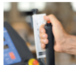
Zusatztastatur und Not-Aus-Schalter im Handgriff
