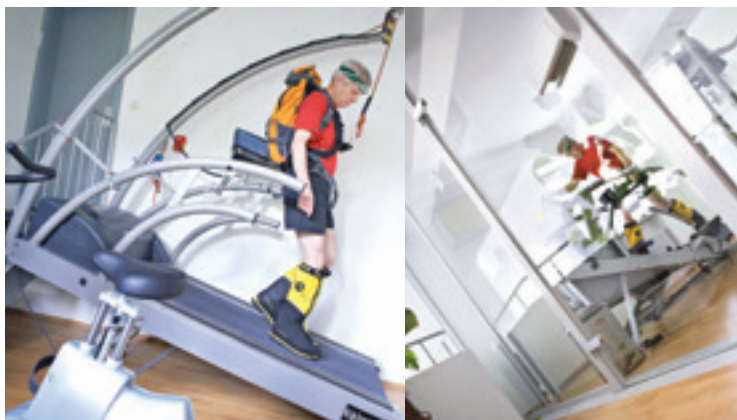
Laufbandinstallation in einer Höhenkammer für Training unter Hypoxie
