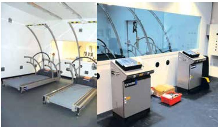
zwei Klimakammer-Laufbänder mit externen Bedieneinheiten außerhalb der Klimakammer
