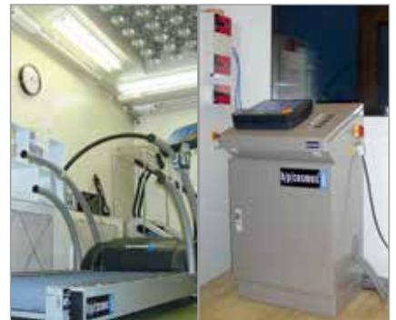
Speziallaufband für Klimakammer-Installation mit Fernsteuerung
