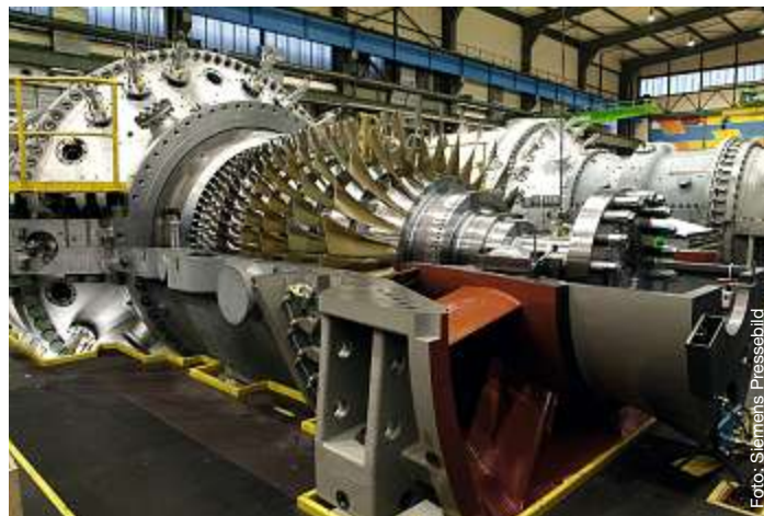
Die Siemens-Gasturbine SGT5-4000F bei der Endmontage im Werk Berlin
