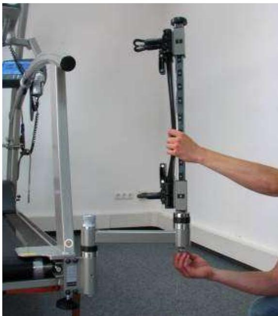
16.1. Fixieren Sie den Vertikalträger leicht mit Scheibe und Mutter.
