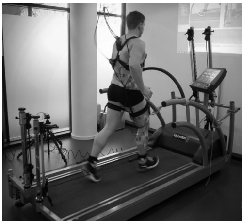
Abbildung 1: ROBOWALK System; hier mit Zug am Oberschenkel nach vorn
