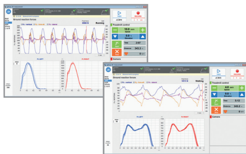
ゲイトウェイ3dトレッドミルでの3コンポーネンツ計測, F_z , F_y , F_x ランニング中(左) 歩行中(右)
