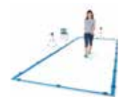
バイオメカニクスゲイトパラメーター Optogait オプトゲイト
