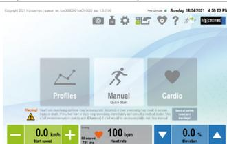
MCU6 Startscreen. Das Kamerasymbol erzeugt einen Screenshot der automatisch in die Zusammenfassung integriert und als separate Datei auf dem USB Stick abgelegt wird.
