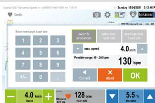
Der Cardio-Modus erlaubt das Training mit Ziel-Herzfrequenz oder max. Geschwindigkeit um die physische Belastung durch Geschwindigkeit & Steigung zu kontrollieren.
