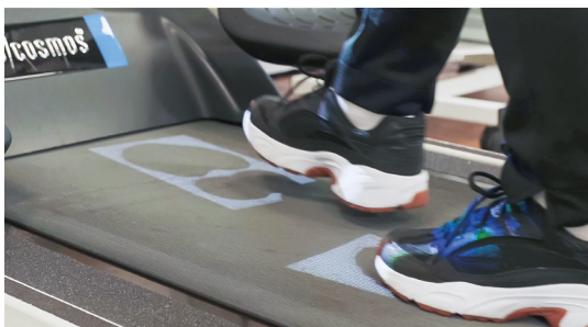
Adaptive visuelle Stimulation [cos101291-01] mit Schrittprojektion auf dem Laufgurt
