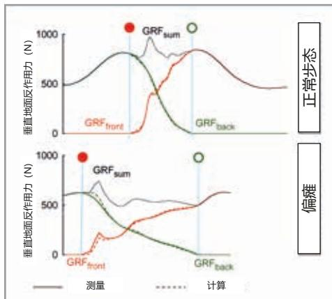
双脚触地期间地面反作用力：实测（实线）及经计算分解后重建（虚线）。请注意部分虚线被实线遮挡。细实线为 Ffront 及 Fback 的总和 (Fsum)。双脚触地阶段被分解为前脚触地（红圈）和后脚离地（绿圈）。
