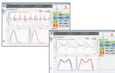
运用 gaitway® 3d 跑台对跑步（左图）和步行（右图）进行三分力 Fz,Fy,Fx 测量
