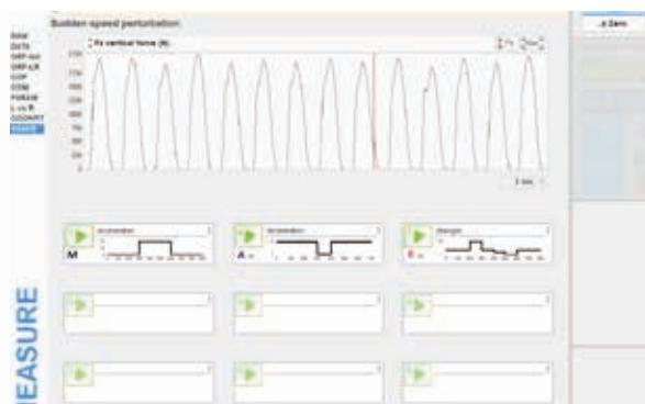
gaitway®3d 扰动系统 (震动) 可通过突然改变速度进而模拟跌倒
