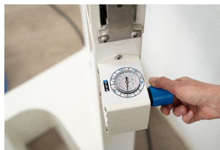
Abbildung 12. Einstellen der Entlastungskraft
