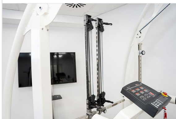
Abbildung 21. Verschieben der vorderen Expanderträger
