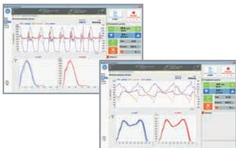
gaitway® 3d でのランニング時(左)とウォーキング時(右)の 3 方向力測定  $F_z, F_y, F_x$
