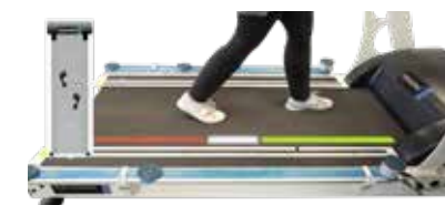
h/p/cosmos SpeedControl [cos101000_speed_control] basiert auf einem optometrischen System und ermöglicht eine automatische Anpassung der Geschwindigkeit und Steigung an die Position des Probanden auf dem Laufgurt
