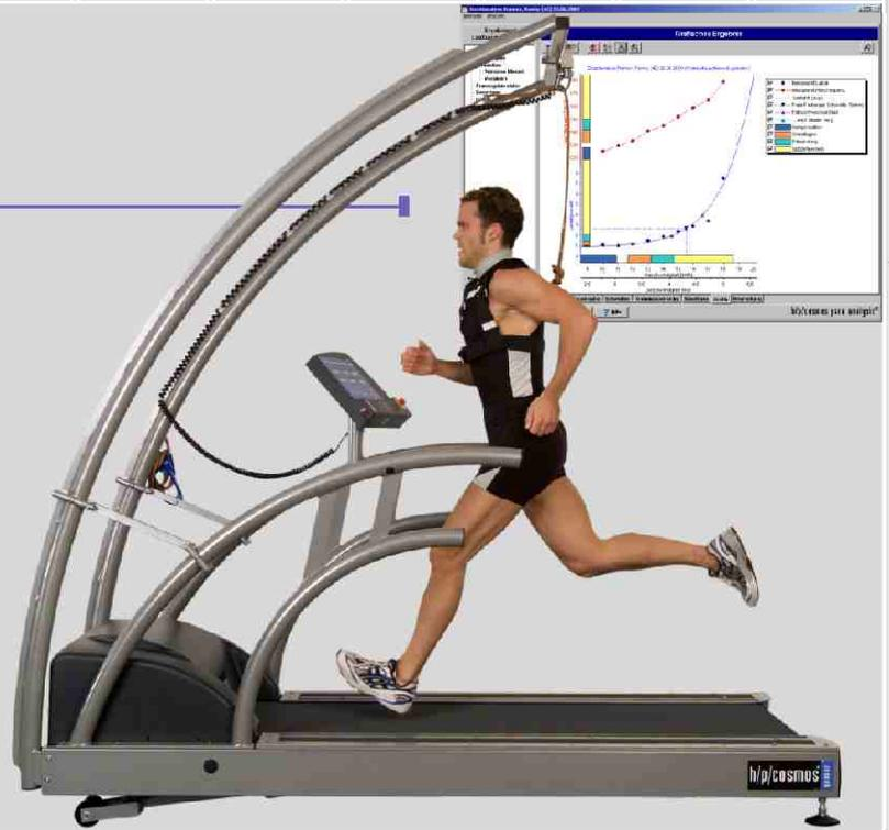
Die Software h/p/cosmos para control steuert alle h/p/cosmos Laufband-Ergometer. Vor allem Modelle ohne UserTerminal benötigen zur Steuerung eine Software. Zum besseren Verständnis wurde hier der Screenshot in den Monitor eines Laptops platziert.
