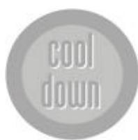
Klickt man während eines Stufentests auf den Cool-Down Button, beginnt die individuell programmierte Nachbelastungsphase, andernfalls wird der Test beendet. Nach Ablauf der Nachbelastungsphase bleibt das Laufband-Ergometer stehen und es öffnet sich wiederum automatisch ein Fenster zum Speichern des Protokolls.
