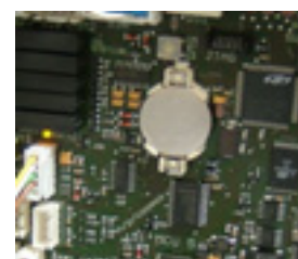
Bild: batteri [cos12542] på MCU5-kretskort
